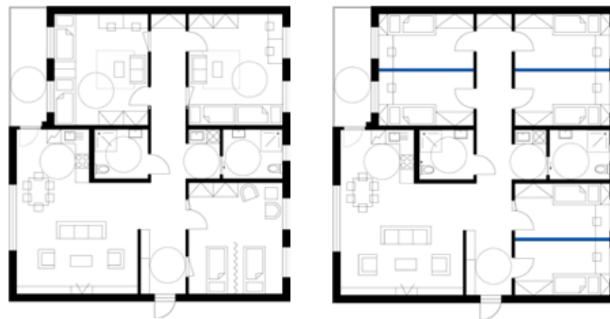
Obr. 7.9: Príklad priestorovej flexibility v upraviteľnom byte pre šesť užívateľov – izby sú dimenzované tak, aby mohli byť jednoposteľové alebo dvojposteľové; priestory izby možno predeliť montovanou priečkou, závesom a pod.
