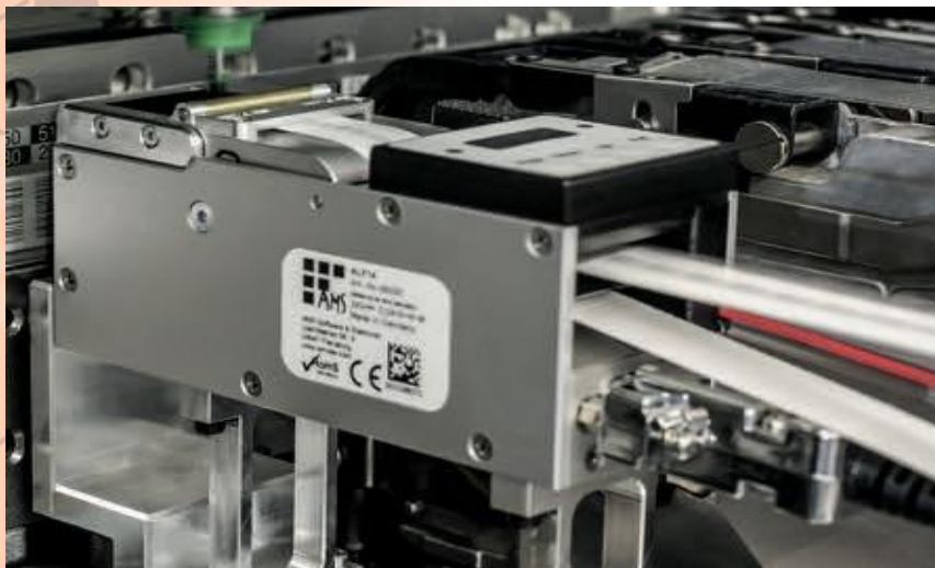
Obrázok 1: Automatický podávač etikiet integrovaný do výrobnjej linky
