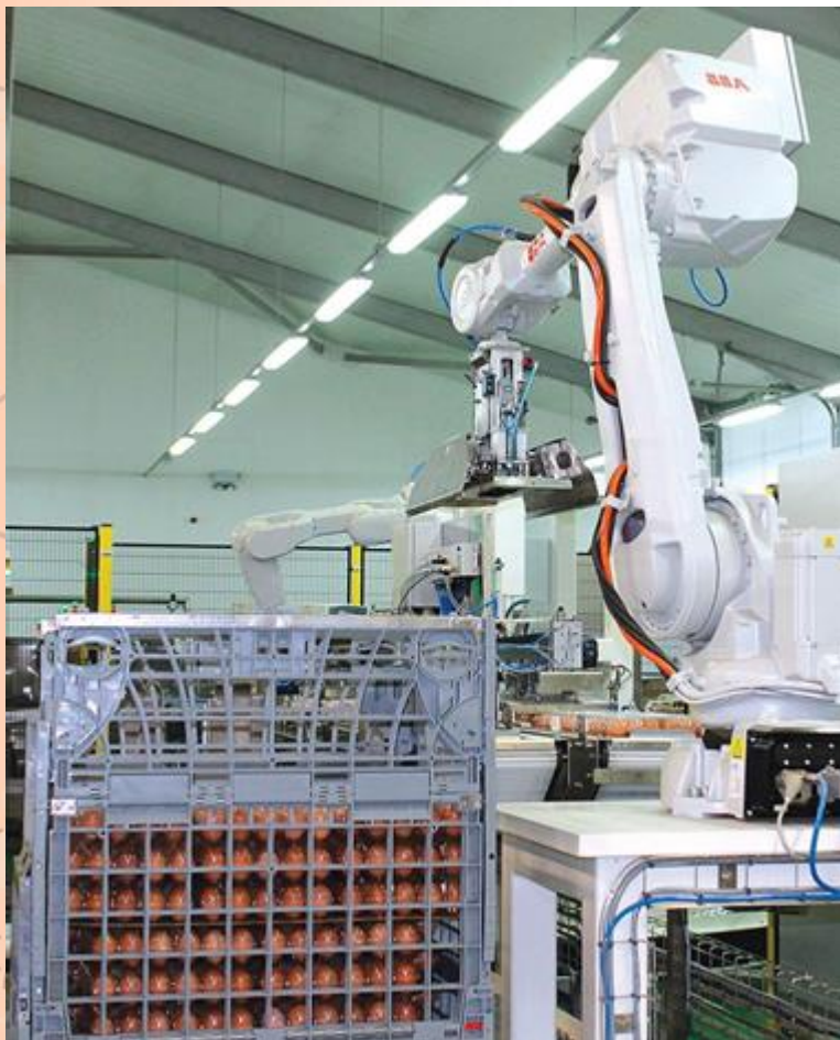
Obrázok 3: Robotické paletovacie zariadenia na balenie čerstvých vajec bezpečným spôsobom
