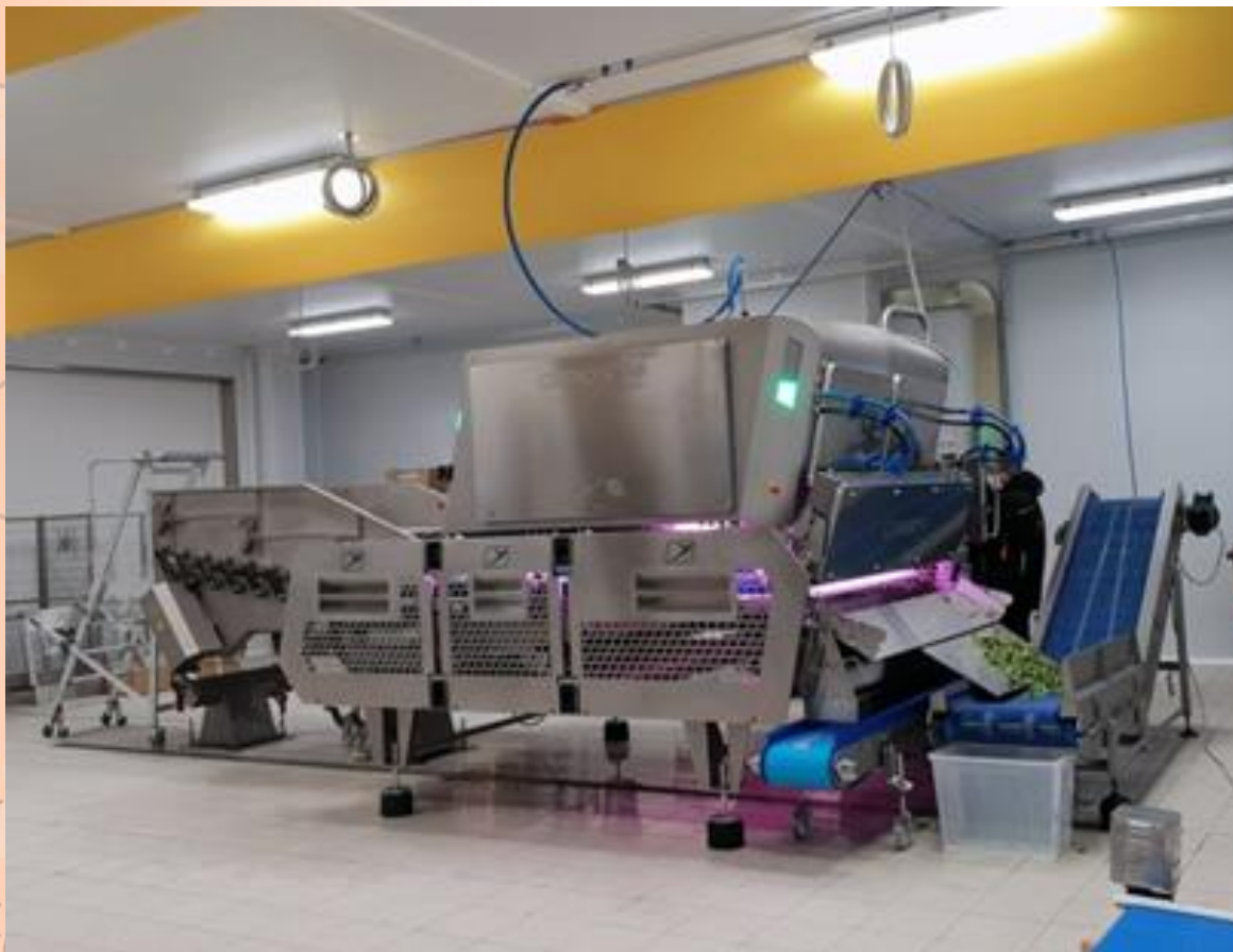
Obrázok 4: Technológia optického triedenia zlepšujúca selekčnú analýzu v sektore čerstvej krájanej zeleniny
